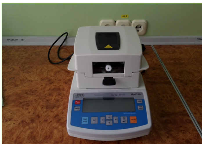
Прибор для определения содержания влаги в продуктах
