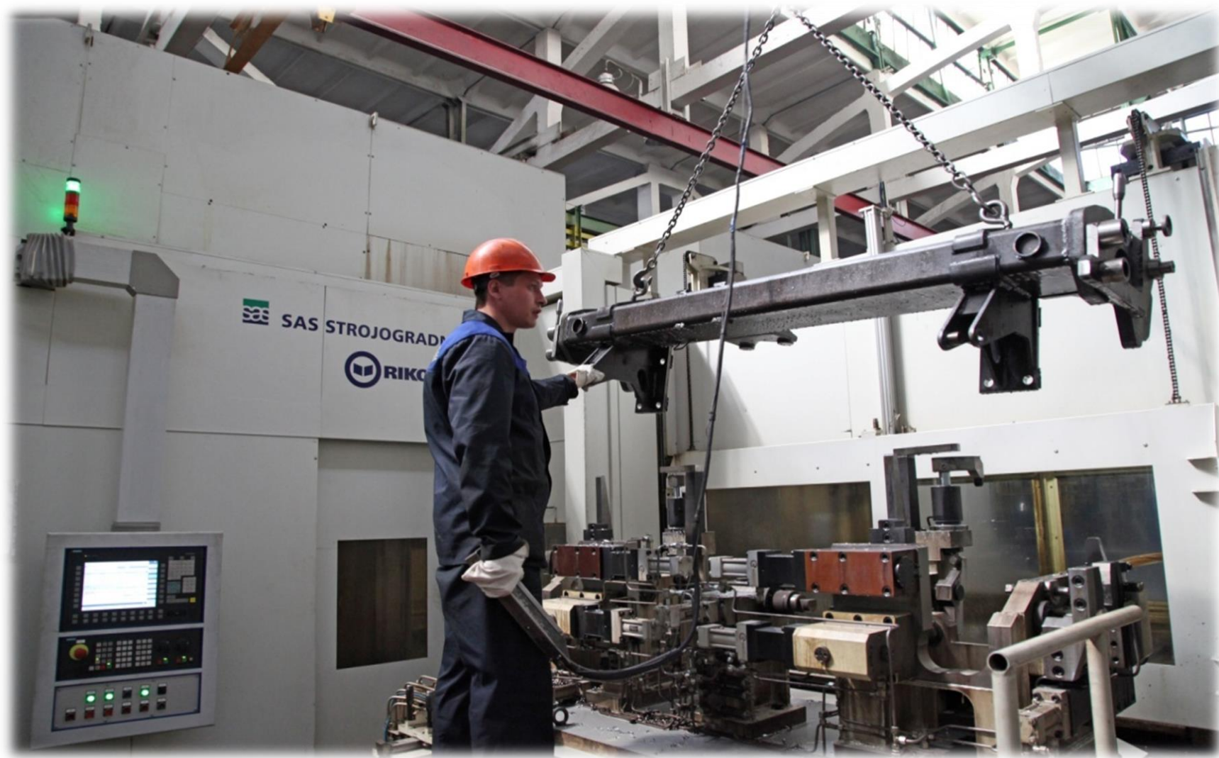
Двухсторонний горизонтальный обрабатывающий центр для комплексной обработки балки моста «RIKO», Словения
