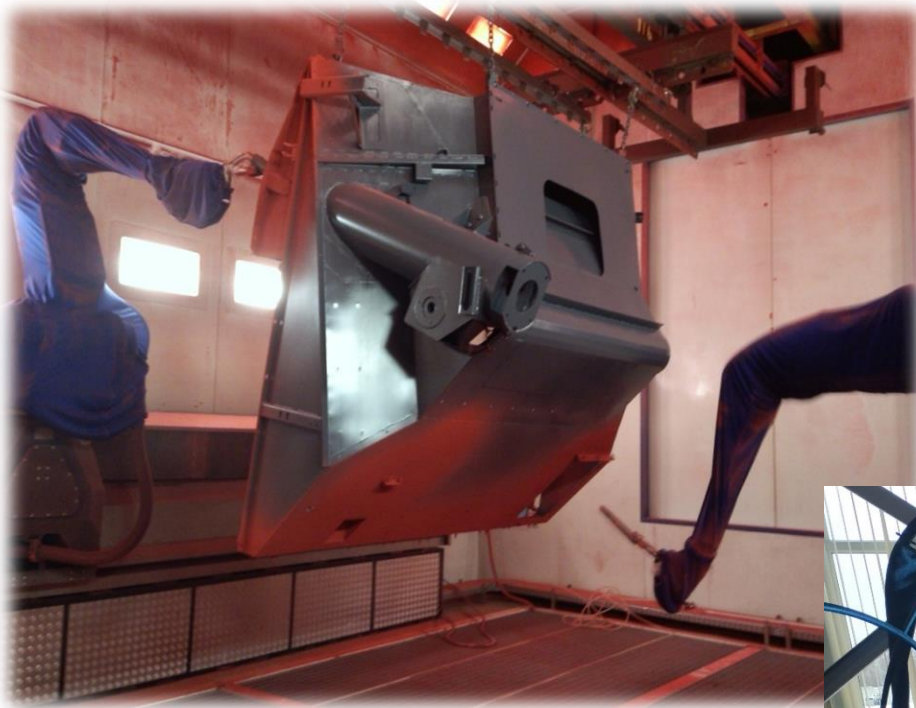
Автоматическая линия окраски порошковыми и водоразбавляемыми красками с нанесением катафорезных грунтов, Италия
