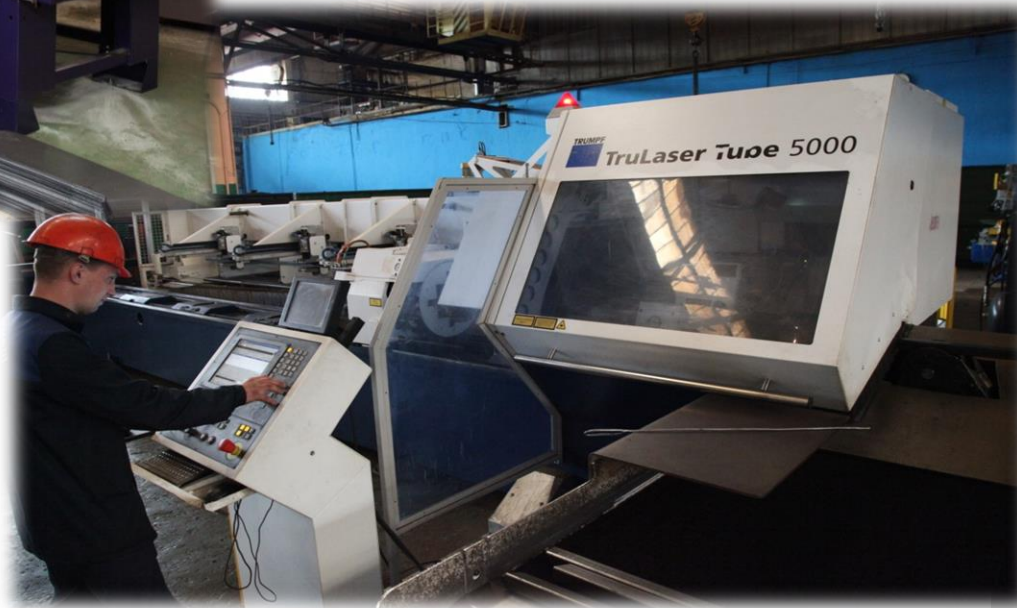
Комплекс лазерной резки труб и сортового проката «TruLaser 5000», Германия.
